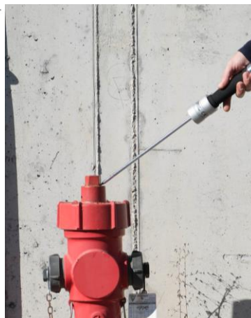
SONDA S40B PER LA PRE-LOCALIZZAZIONE PERDITE SU RETI ACQUEDOTTISTICHE , IMPIANTI CIVILI ED INDUSTRIALI
