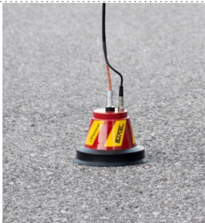
GEOFONO S40A PER LA LOCALIZZAZIONE PERDITE SU RETI ACQUEDOTTISTICHE , IMPIANTI CIVILI ED INDUSTRIALI
